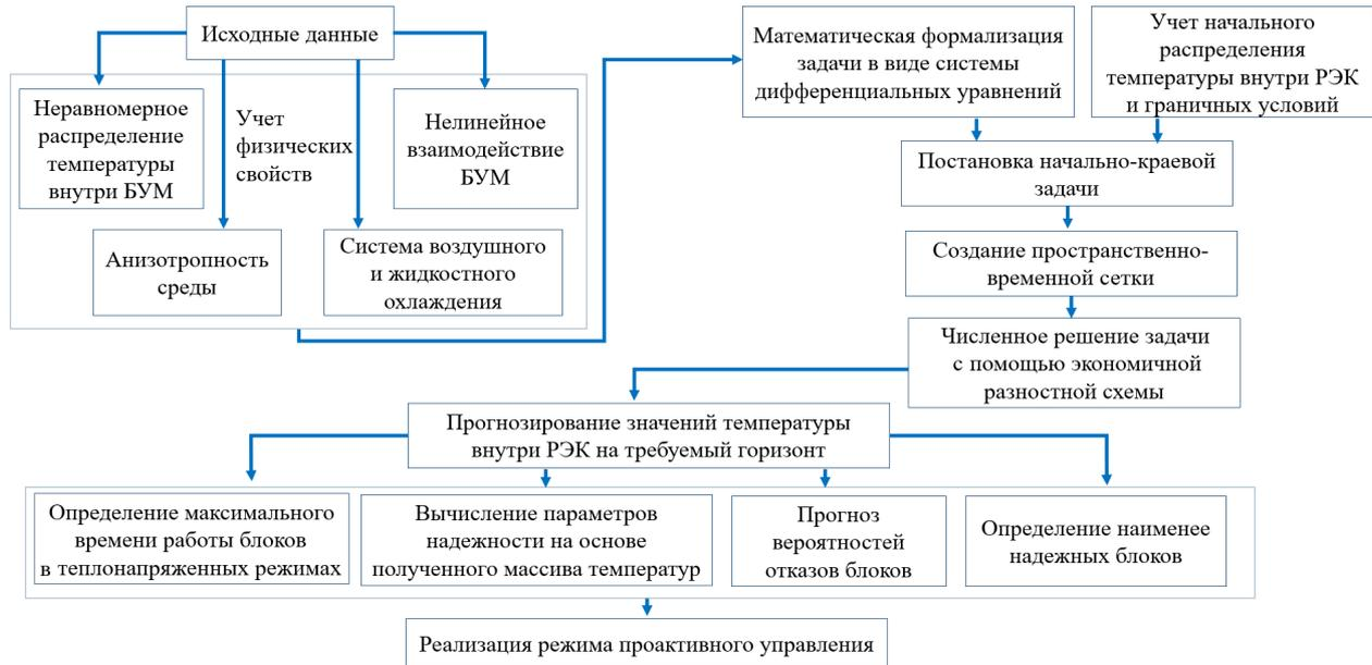
Рис. 2. Блок-схема алгоритма учета тепловых процессов в интересах проактивного управления радиолокационной станцией
