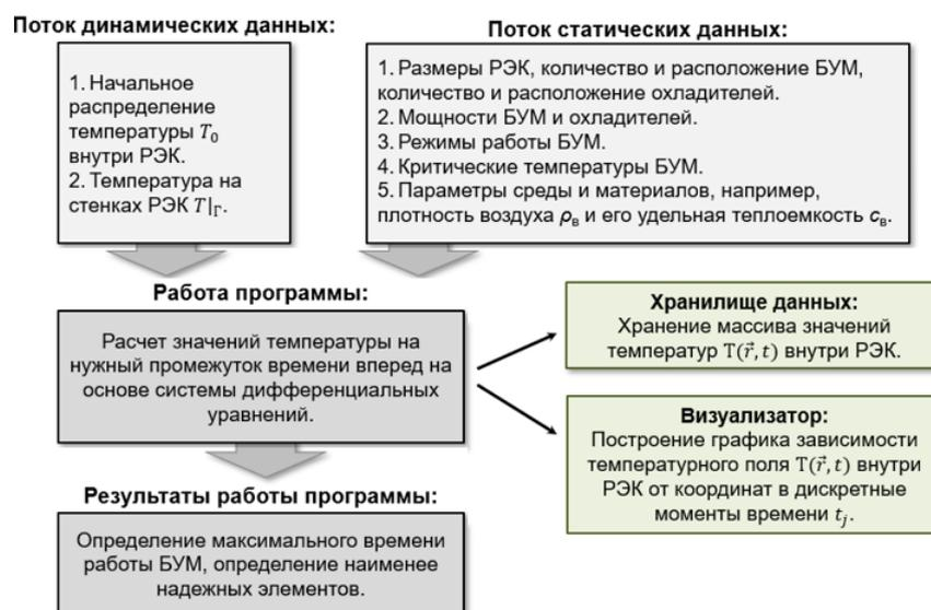
Рис. 3. Блок-схема работы программы
