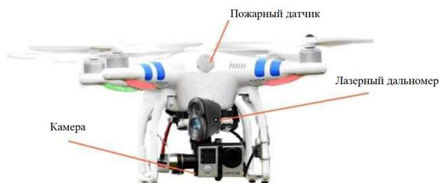
Рис. 6. Конструкция квадрокоптера
