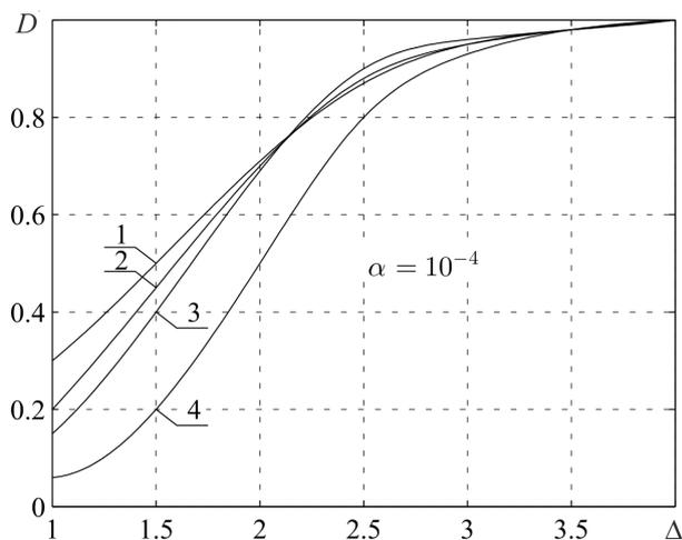
Рис. 4. Зависимость вероятности правильного обнаружения от сдвига: кривые 1–3 — совместные алгоритмы (Вилкоксона и превышающих наблюдений) при  $\mu = 3; 2.5; 2$  соответственно; кривая 4 — алгоритм Вилкоксона,  $\mu = 2.5$
