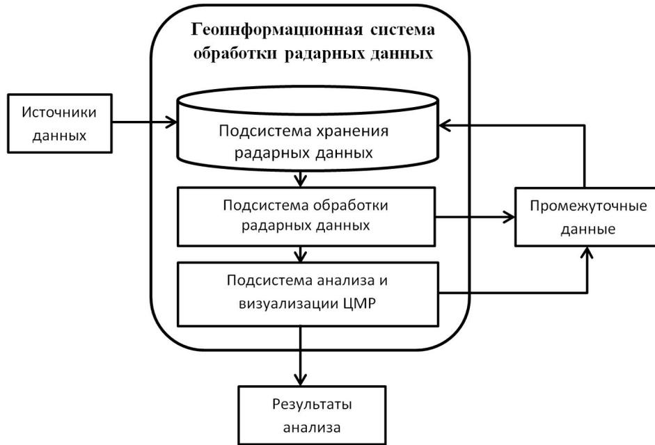
Рис. 2. Общая схема информационно-вычислительной системы геодинимического мониторинга на основе радарных данных дистанционного зондирования
