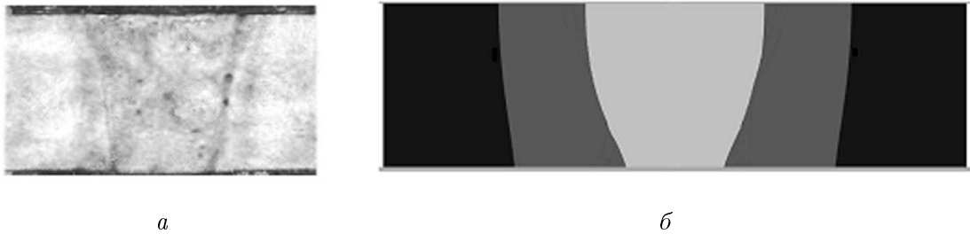
Рис. 6. Фотография шлифа (а) сварного шва в плоскости, перпендикулярной сварному шву (видна граница застывшей ванны), и сечение расчетной области (б) плоскостью, перпендикулярной оси x в точке с максимальной шириной ванны (область ванны отмечена наиболее светлым оттенком)
